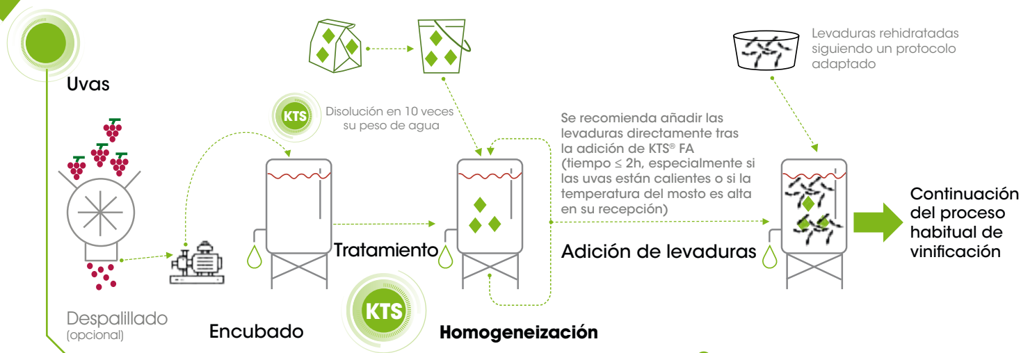
Figura 10: Ejemplo de protocolo para el tratamiento de un mosto con KTS® FA en el encubado
